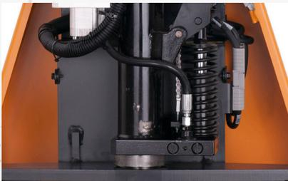
Pompe à commande manuelle avec levage rapide
