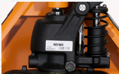
Pompe hydraulique étanche et moulée d'une seule pièce
